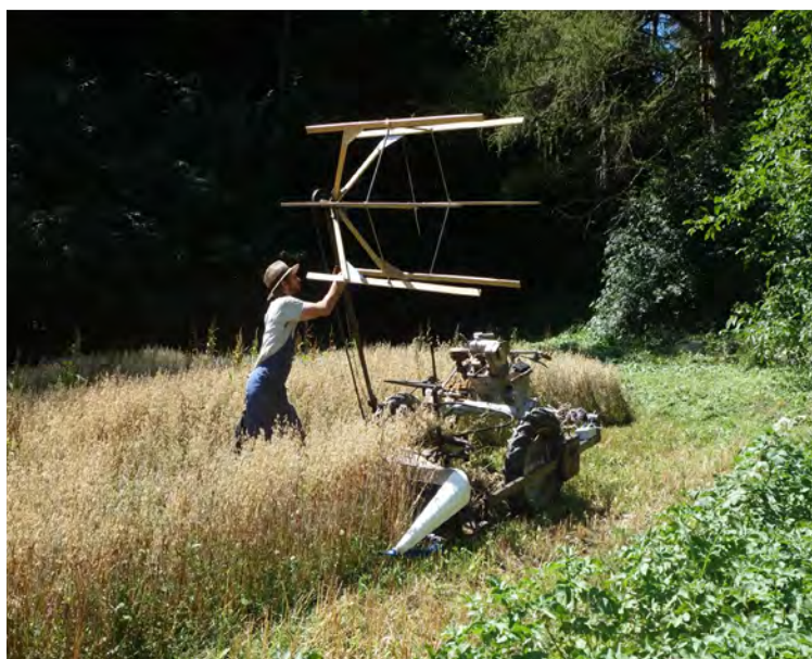
05 — Traditioneller Mähbinder: ein Beispiel für eine Maschine, die von Retrofit-Lösungen profitieren kann, etwa durch die Integration einer elektrischen Kopplung in Bergtraktoren. Foto: Agroforestry Innovation Lab
