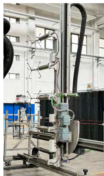
04 – Vorrichtung zur vertikalen Verteilung von Luftströmen zur Bewertung der Leistung von Sprühgeräten in Obstplantagen. Foto: Agroforestry Innovation Lab
