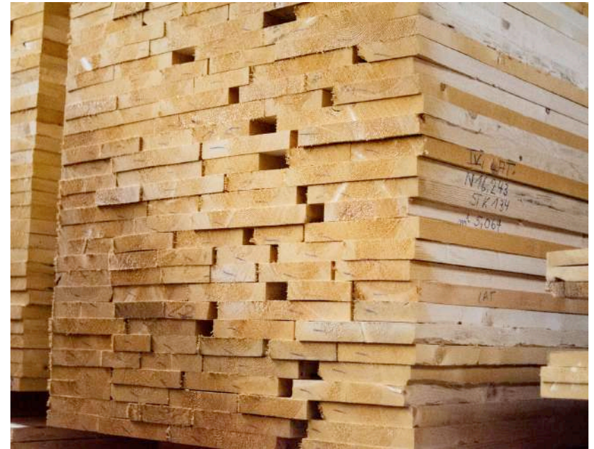
Assi di abete rosso divise per qualità ed accatastate alla segheria del Latemar
