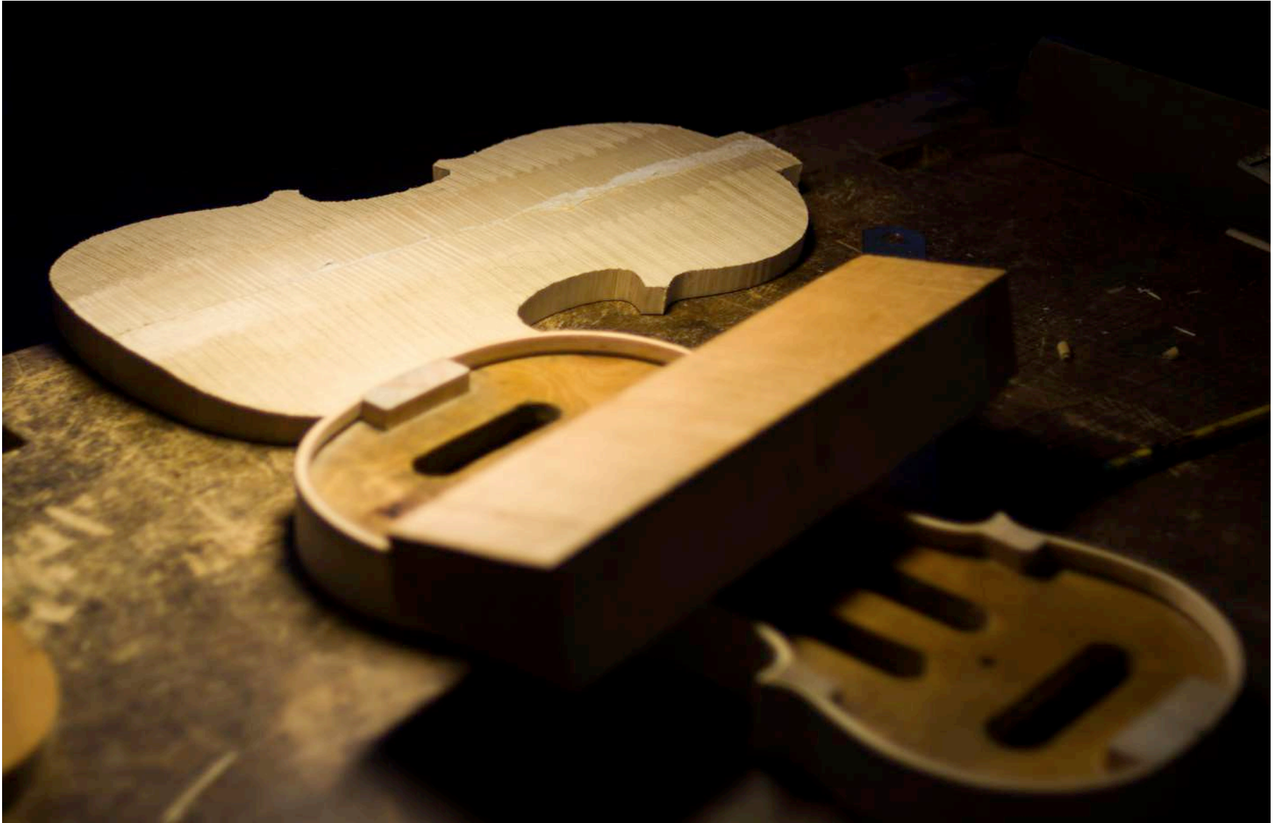
Fondo, fasce e manico di un violino in lavorazione alla scuola di liuteria di Cremona.
